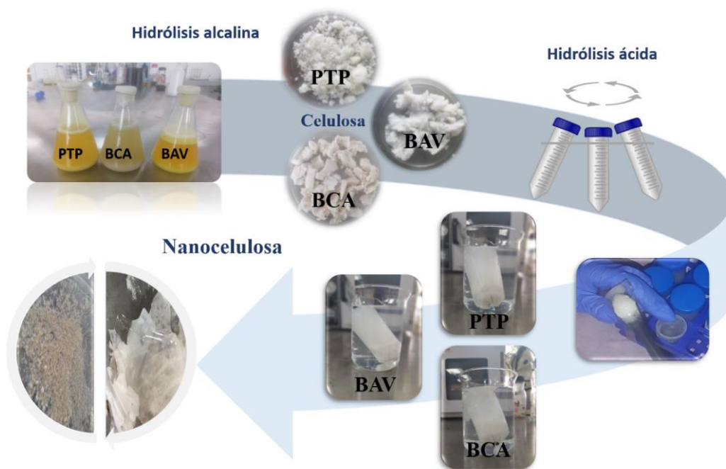
Figura 5.16 Proceso de extracción de cristales de nanocelulosa (CNC) de residuos agroindustriales de BAV, PTP y BCA, mediante hidrólisis ácida de H_2SO_4 .
