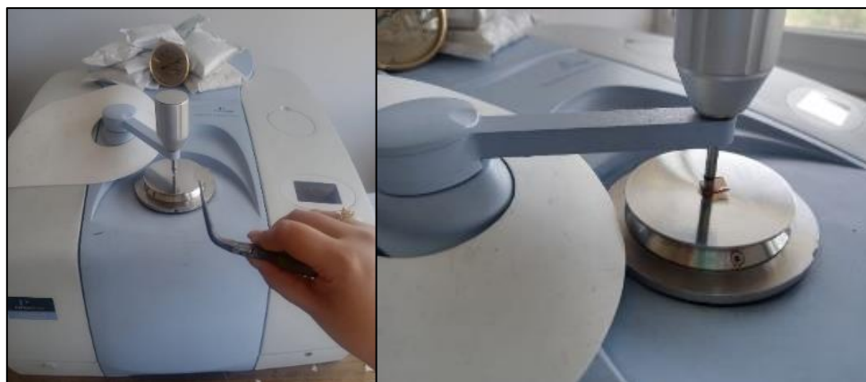
Figura 2.5 Espectrofotómetro de infrarrojo con Transformada de Fourier Perkin Elmer, modelo Spectra 100.
