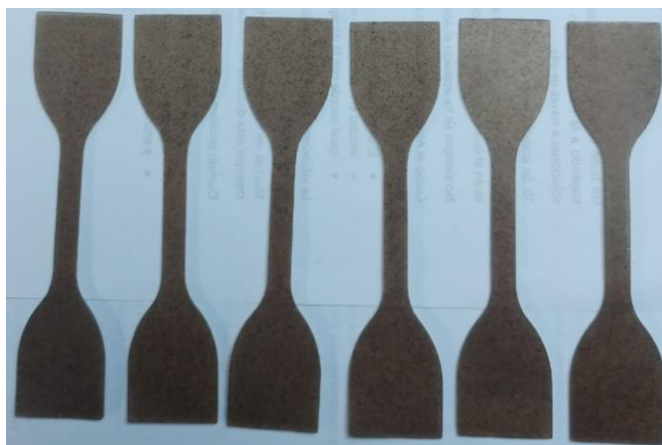
Figura 2.6 Probetas suajadas con referencia a la norma ASTM D412-68.
