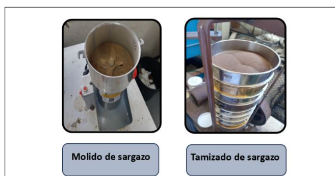
Figura 2.3 Preparación de las partículas de sargazo (SgP).
