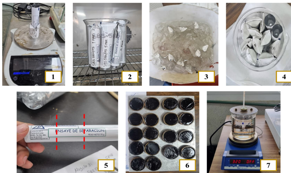
Figura 2.6 Proceso de la prueba de separación de fases.
