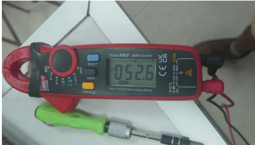
(a) Voltaje de salida del convertidor.
