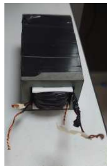
(b) Transformador terminado.
