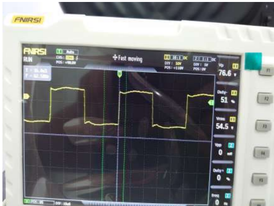
(a) Señal de entrada al transformador.
