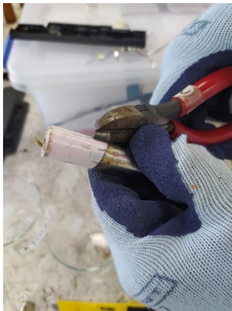
Figura 11 Proceso de desmantelamiento de una batería de litio.
