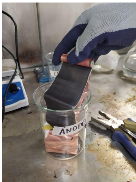
Figura 13 Separación de la placa del ánodo, es fácilmente identificable debido al color característico del cobre.
