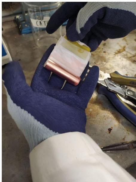
Figura 12 Obtención del electrodo en rollo de la batería.
