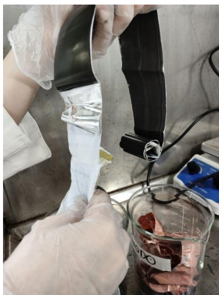
Figura 14 Separación de la placa del cátodo, el aluminio al que el componente de litio está adherido ayuda a identificarla.
