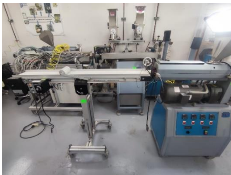
Figura 2-2 Arreglo final del equipo de extrusión junto al sistema de jalado para la obtención de filamentos.
