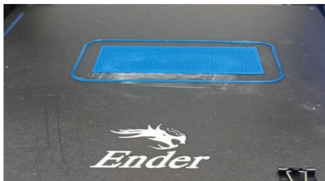
Figura 3-3 Base de adhesión de PLA propuesta en primera instancia.
