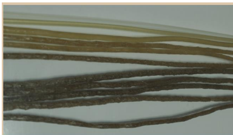
Figura 3-2 Apreciación de la rugosidad presente en los filamentos obtenidos, ordenado del PP puro y aumentando de 0.5 PHR conforme se descende en la figura.
