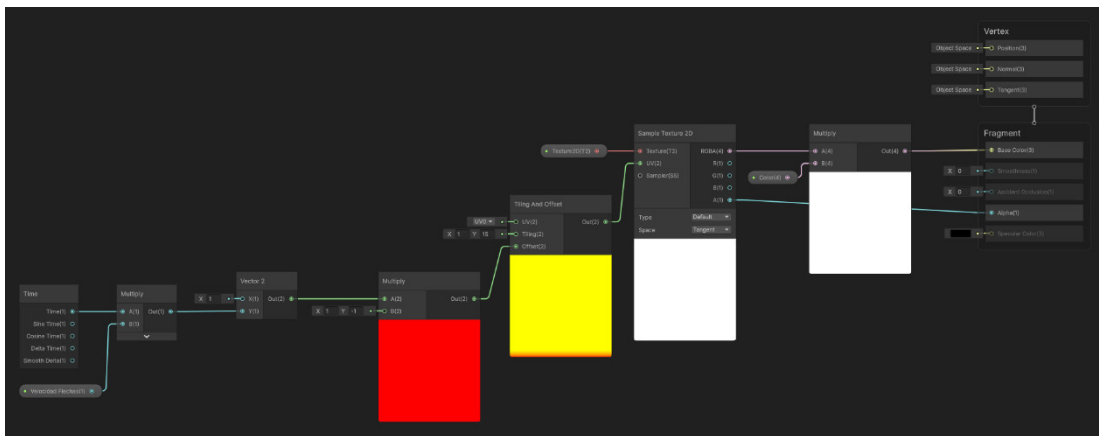
Figura 49: Shader desarrollado para simular el movimiento de las bandas transportadoras con Shader Graph, en Unity 3D.
