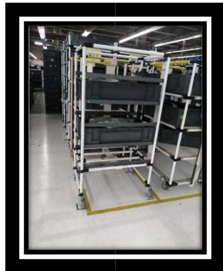
Ilustración 13: Carro SA (Producto Semi Acabado); con modificación para transporte de MIR
