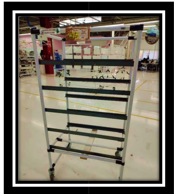
Ilustración 15: Propuesta de carro SA (Producto Semi Acabado); con modificación y ayudas visuales para transporte de MIR
