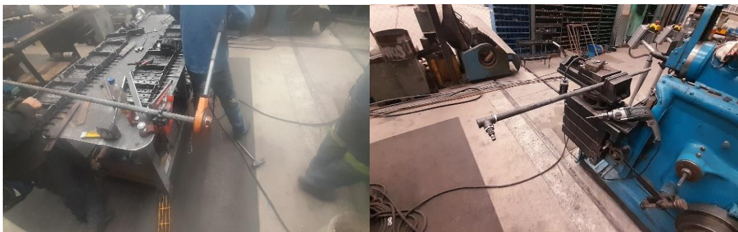
Figura 3.44 Realización de cuerdas a tubería neumática, cédula 40 y conexión de racores.
