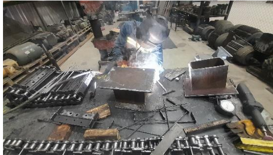
Figura 3.43 Fabricación de bases para pistones de los mecanismos de compuerta.
