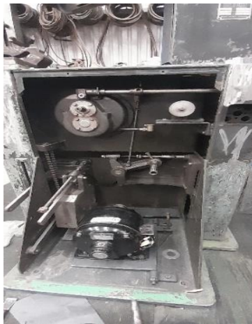
Figura 3.85 Instalación de cada uno de los mecanismos de la sierra cinta.
