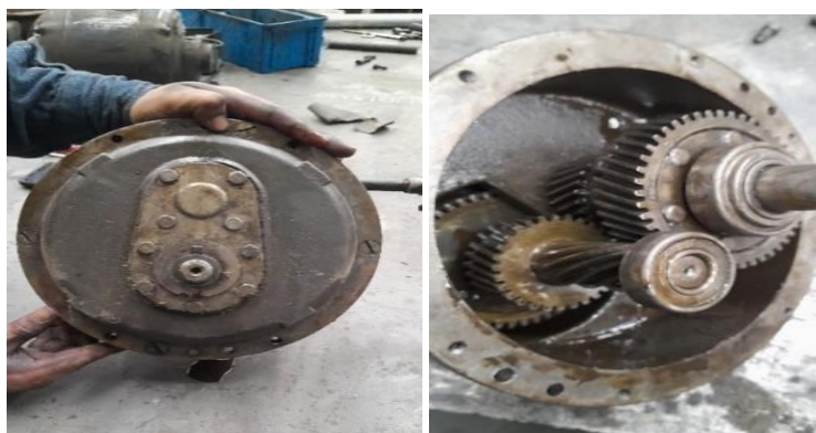
Figura 3.82 Mantenimiento de caja de engranajes.
