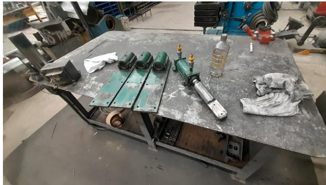
Figura 3.65 Limpieza y mantenimiento a bases y cuñeros de las horquillas tipo I de los topes
