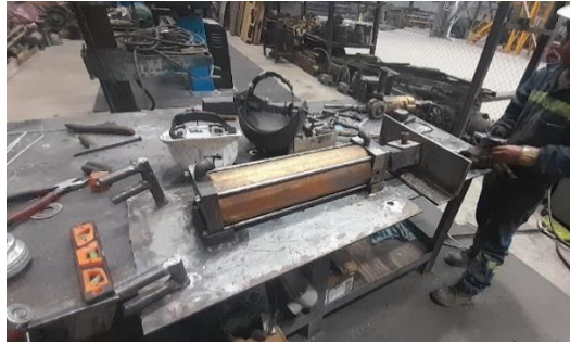
Figura 3.26 Fabricación de soporte móvil para el pistón de empuje.
