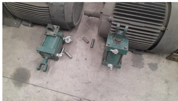
Figura 3.42 Mantenimiento a pistones empleados para el mecanismo de compuerta.
