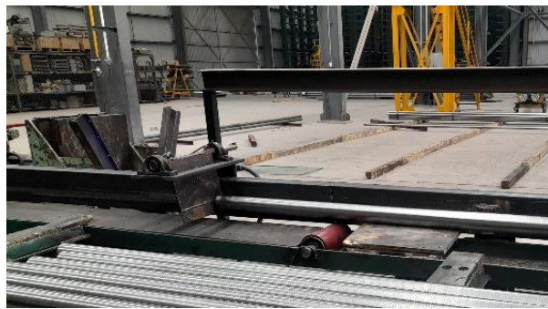
Figura 4.7 Descarga de barras de forma automática.
