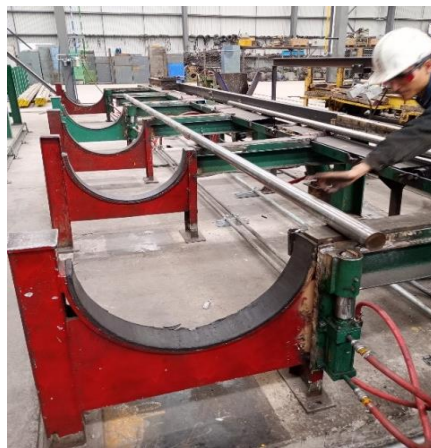
Figura 4.9 Accionamiento de topes de material.
