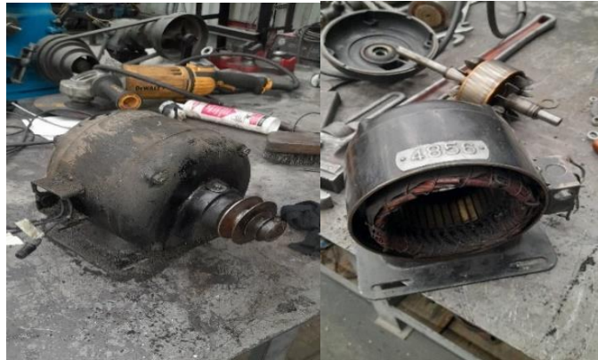
Figura 3.76 Mantenimiento a motor eléctrico.
