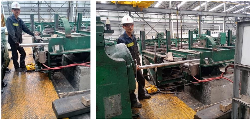
Figura 4.4 Modificación del proceso en la entrada de barras a los rodillos.
