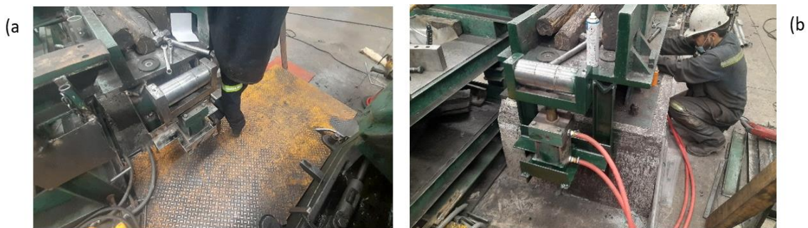
Figura 3.20 Fijación y colocación de manguera neumática del pistón de levantamiento.
