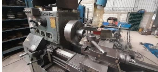
Figura 3.15 Operación de mandrinado para cada uno de los rodillos.
