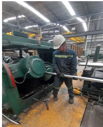
Figura 4.3 Operador introduciendo barras a los rodillos de la máquina roladora de forma manual.
