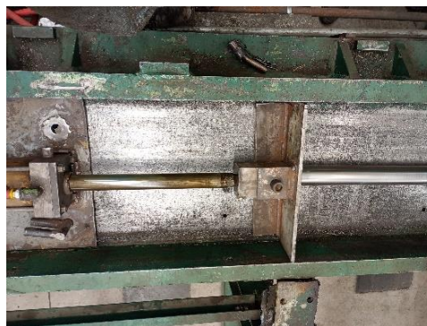
Figura 4.5 Pistón de empuje en funcionamiento.
