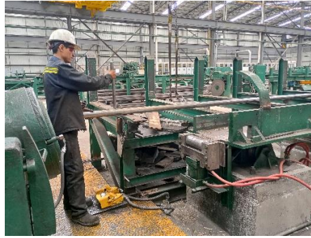
Figura 4.2 Modificación del proceso de colocación de barras en el canal de entrada.
