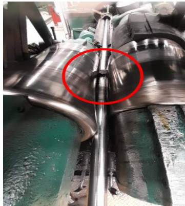
Figura 3.60 Barra de entrada empujando a la barra previamente introducida.
