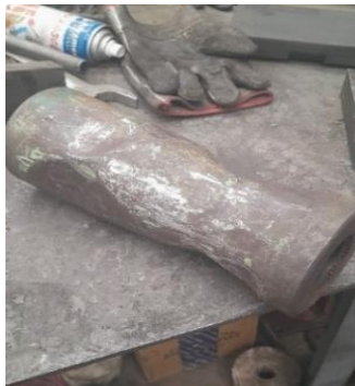
Figura 3.14 Rodillo de pistón de levantamiento con abolladuras y desgaste.
