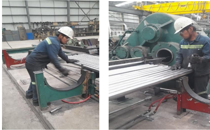
Figura 4.8 Colocación y retiro de topes de forma manual.
