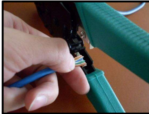
Figura 84 Pelado de cables [Fuente propia 2023]
