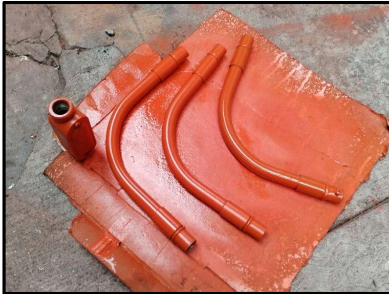
Figura 60 Codos, Conectores y Condulets para tubería Conduit [Fuente propia 2023]
