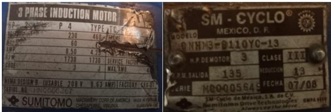
Ilustración 48. Placa de datos motorreductor opción A. (Fuente: propia)
