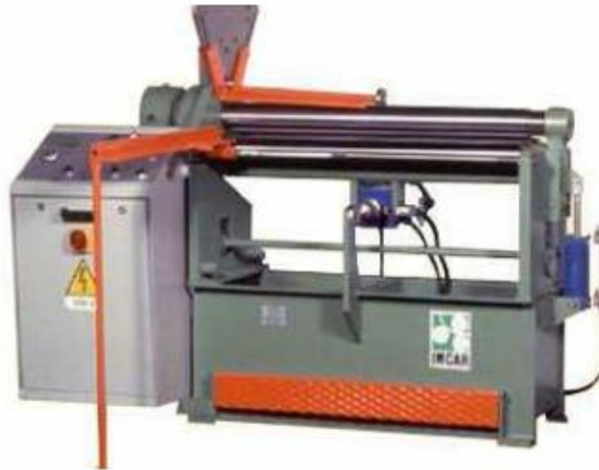
Ilustración 20. Roladora neumática Tech. (Fuente: http://www.dismamex.com.mx/imcar.html )
