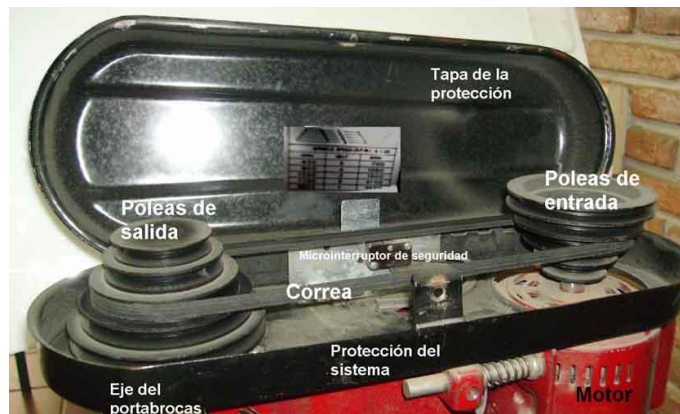
Ilustración 37. Trasmisión por correa en torno de sobremesa. (Fuente: https://www.cienciasfera.com/ )
