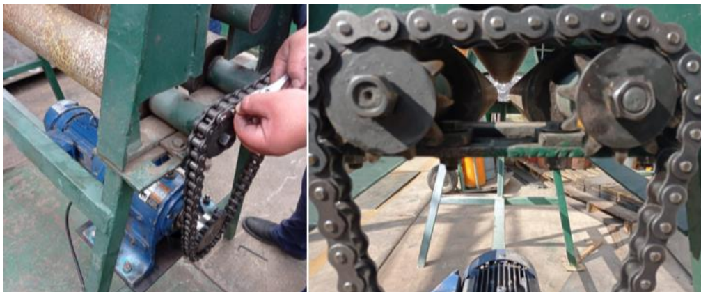
Ilustración 75. Ajuste y colocación de cadena. (Fuente propia)
