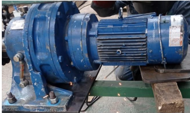
Ilustración 65. Motorreductor SUMITOMO. (Fuente propia)
