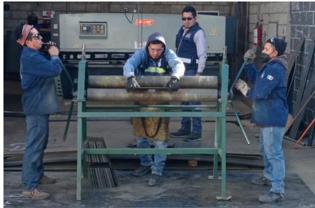
Ilustración 70. Funcionamiento Roladora forma manual. (Fuente propia)
