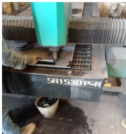
Ilustración 71. Corte por pantógrafo base del Motorreductor. (Fuente propia)
