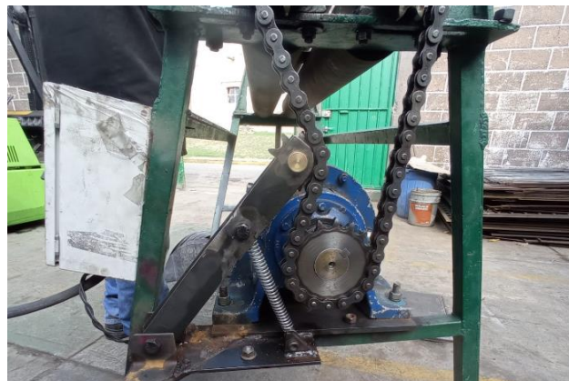
Ilustración 77. Sistema tensor. (Fuente propia)
