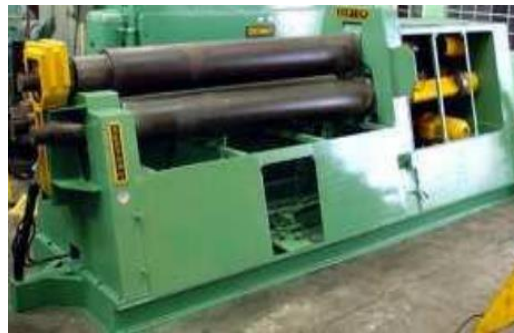
Ilustración 15. Roladora tipo pinch. (Fuente: http://www.dismamex.com.mx/imcar.html )
