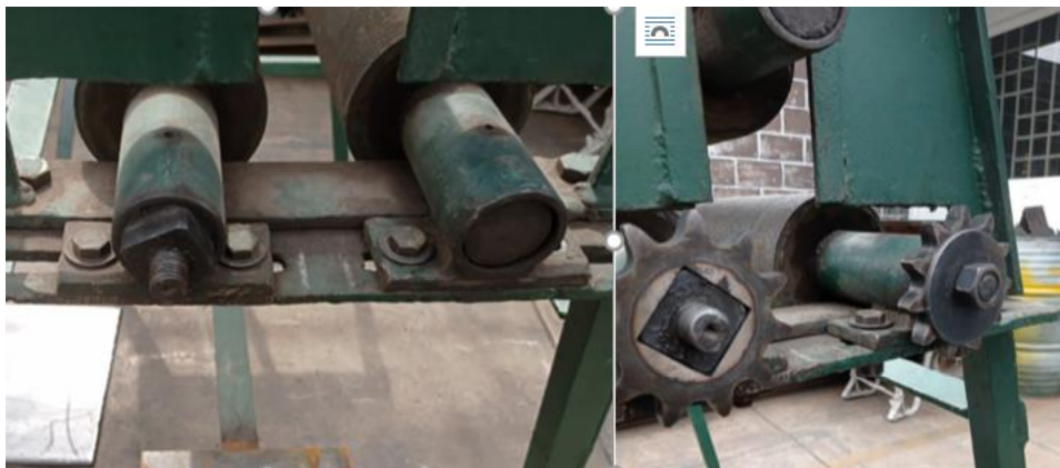
Ilustración 73. Giro del rodillo para acople de Sprockets superiores. (Fuente propia)
