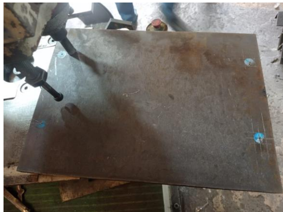
Ilustración 72. Punzonado base del motorreductor. (Fuente propia)
