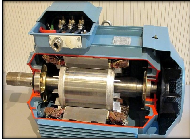
Imagen 1.12 Motor trifásico de corriente alterna
