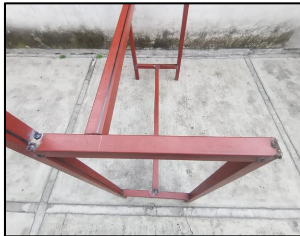
Imagen 2.11 Unión de puntos por medio de electrodo para cortes F3, F4 y T5.
