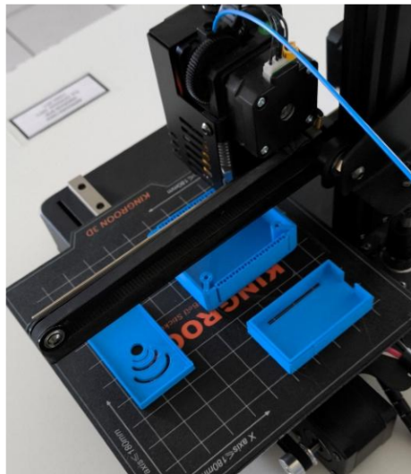
Fig. 4. Impresora Kingroon K3ps utilizada para imprimir los modelos 3D del prototipo Robot Humanoide.
