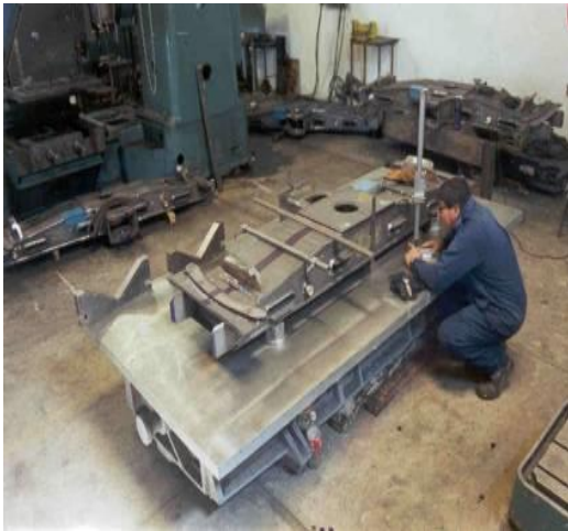
Ilustración 1.4 Maquinado de partes estructurales del truck para tren ligero de Nueva Cork.
