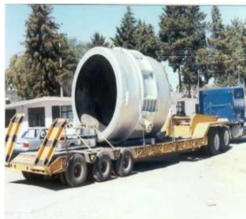
Ilustración 1.9 Olla para transportación de Acero líquido con capacidad de 80 Toneladas
