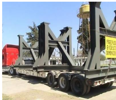
Ilustración 1.7 Estructuras para soporte de turbinas: capacidad 80 toneladas, peso 15 toneladas
