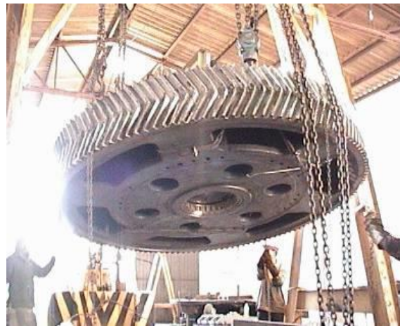
Ilustración 1.5 Maquinado y reparación de ruedas dentadas (dientes, alojamientos para rodamientos) y su montaje en campo
