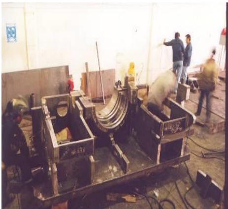
Ilustración 1.6 Pedestales para asiento de rotores de turbinas de 13,000 kg. y 7,800 kg.
