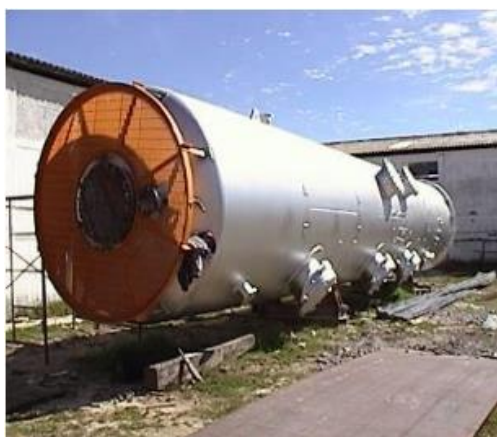
Ilustración 1.8 Construcción de torre de enfriamiento
