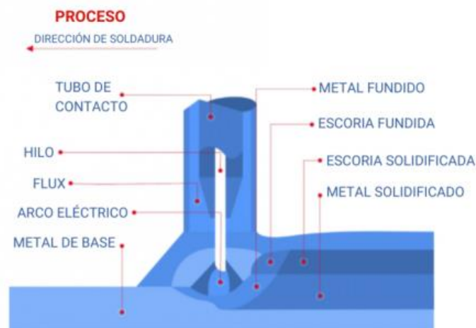
Ilustración 2.2 Esquema del proceso de soldadura por FCAW
