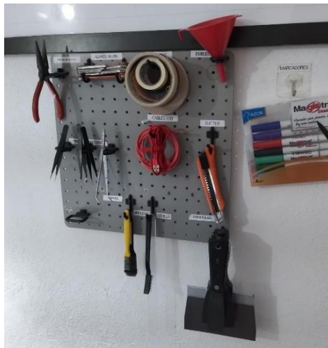
Figura F.7.2.1 Materiales utilizados en el área. Pinzas de corte, pinzas de precisión, brochas y cepillos, espátulas, cintas, embudo, marcadores, cutter, llaves allen y cables USB. Fuente propia.
