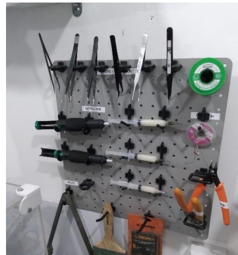
Figura F.7.2.2 Materiales utilizados para soldar y desoldar. Pinzas de precisión, pinzas de corte, pinzas de aluminio, jeringas de flux, limas, carretes de soldadura, malla para desoldar y brocha. Fuente propia.
