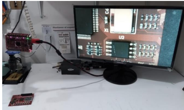
Figura G.4.1 Inspección visual 1:16. Fuente propia.
