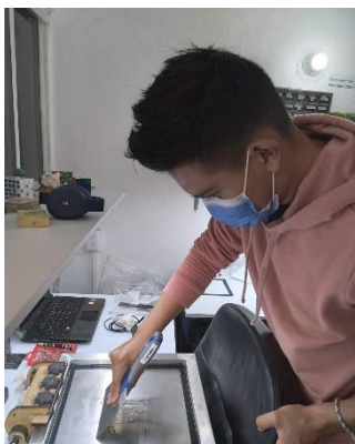
Figura G.1.3 Empastado de la placa PCB. Fuente propia.
