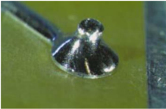
Figura F.5.1 Ejemplo de soldadura cónica o de volcán en componente THT. IPC_A_610_Acceptability_of_Electronic_As.pdf, s/f).
