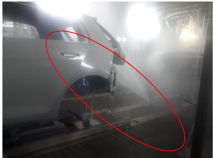
Imagen 6.1.a.. Esprea conectada a la electroválvula [Fuente VWM, Autor; M. Acuña, C. Jiménez, 2017]
