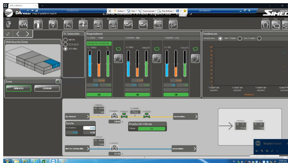
Figura 13 Identificación de zonas de horno y temperaturas correspondientes. Fuente: Elaboración propia
