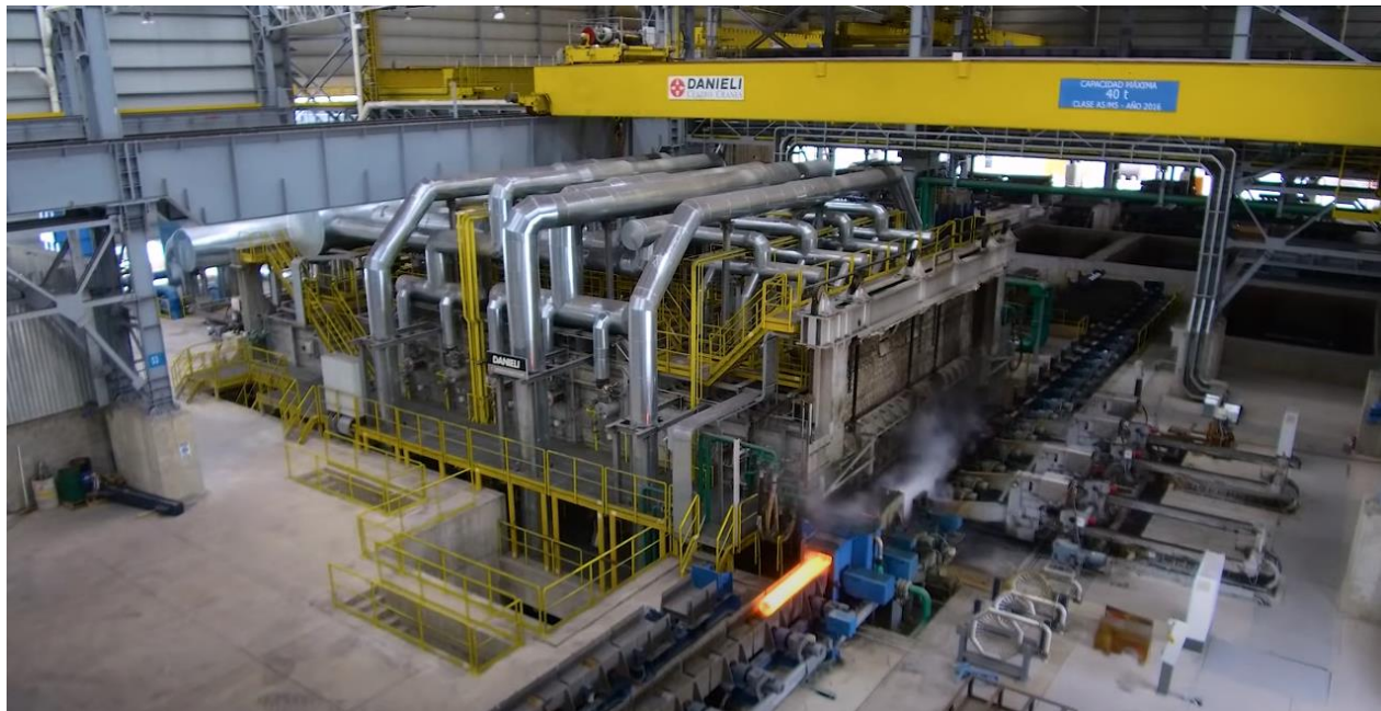
Figura 11 Área de salida de blooms del horno. Fuente: Elaboración propia.
