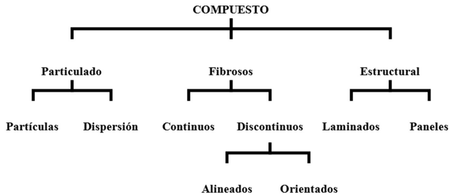
Figura 6 Clasificación de los materiales compuestos.
