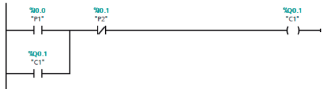
Ilustración SEQ Ilustración \* ARABIC 4: Programación de arranque y paro de un motor por medio de lógica
