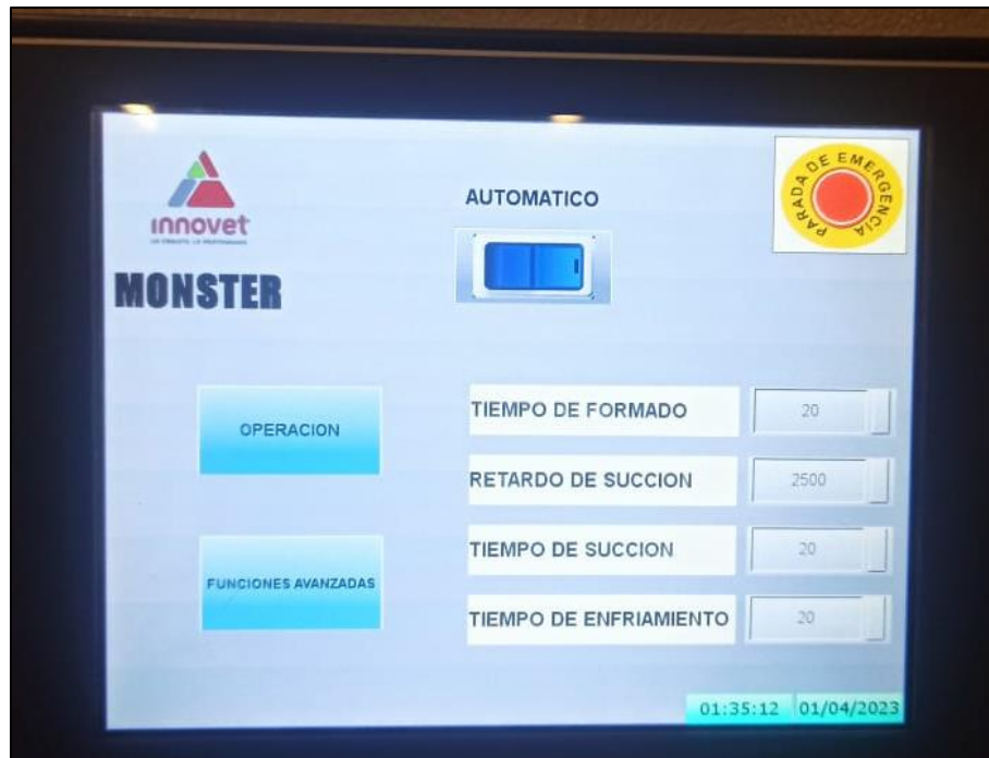
Figura 5.6. Paro de emergencia activado visto desde la pantalla.
