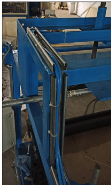
Figura 3.45. Colocación de mangueras en riel en parte superior.
