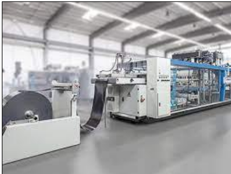
Figura 2.4. Máquina termoformadora automática.
