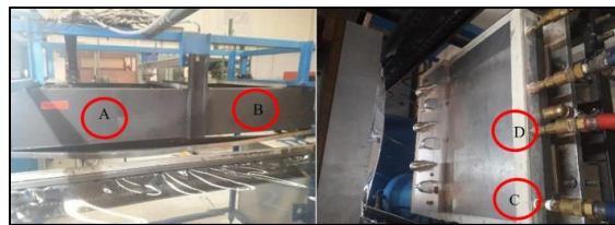
Figura 3.28. Horno y base de enfriamiento.
