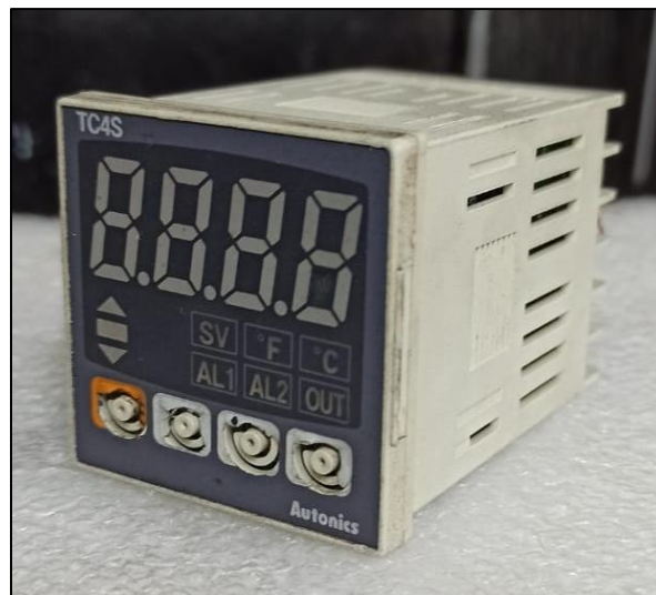
Figura 3.23. Controlador de temperatura-TC4S-14R, PID, DIN 48x48, Alarma 1, relevador, salida SSRP, 100 a 240 VCA
