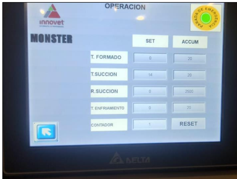
Figura 5.8. Temporizador del tiempo de succión.
