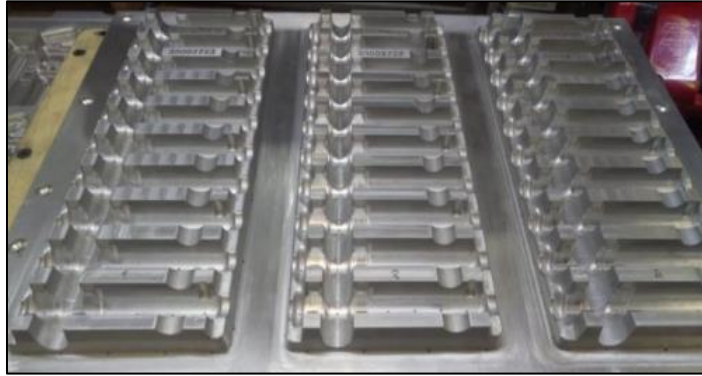
Figura 2.2. Esquema de moldeo en positivo.
