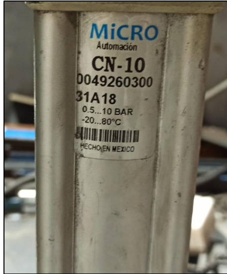
Figura 3.42. Cilindro MiCRO CN-10 0049260300.
