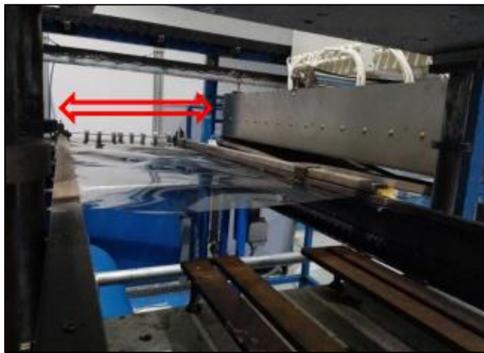
Figura 3.55. Trayectoria de horno dentro de la estructura.
