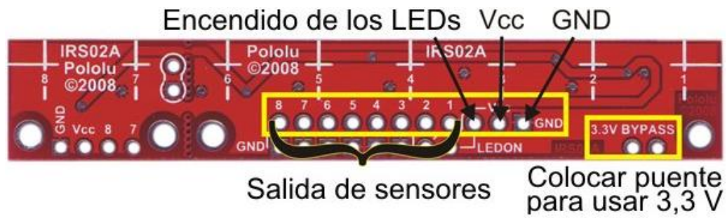
Imagen 99. Barra de sensores TQR 8 de Pololu.
