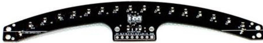
Imagen 222. Barra de sensores multiplexada de Ingeniero Maker.
