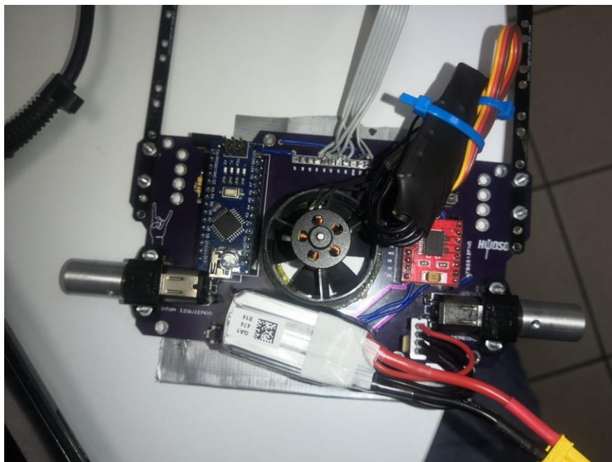
Imagen 208. Seguidor con la turbina, puente H, Arduino Nnano, Motores.
