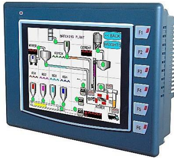
Fig. 20. HMI terminal de operador.
