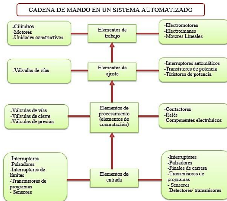
Fig. 4. Cadena de mando en un sistema automatizado
