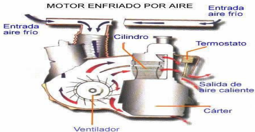
Ilustración 25 Funcionamiento del sistema de refrigeración por aire
