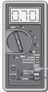
Figura 92 Multímetro digital con función "diode test"
