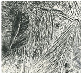
Figura 7.4: Estructura microscópica de acero inoxidable martensíticos
