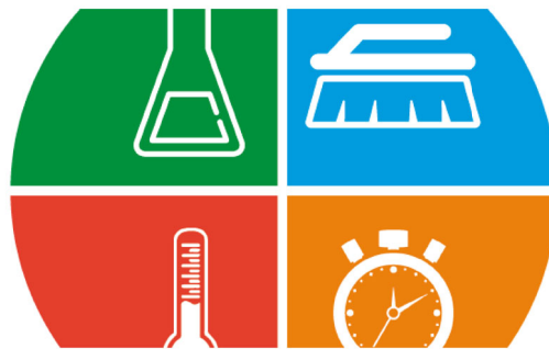
Figura 6.12: Círculo de sinner, para garantizar la efectividad del CIP
