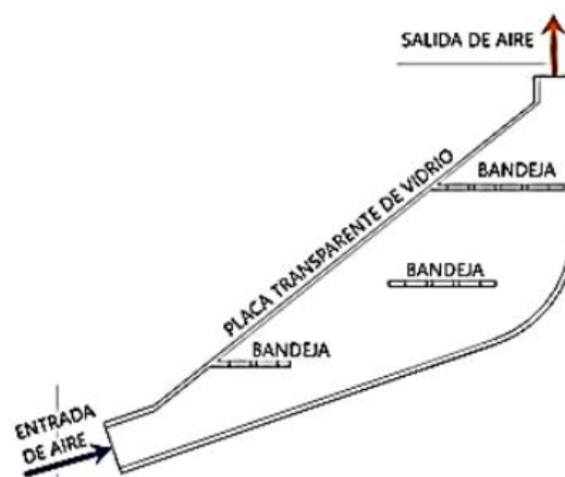
Figura 4.2 Características de la cámara de deshidratación
