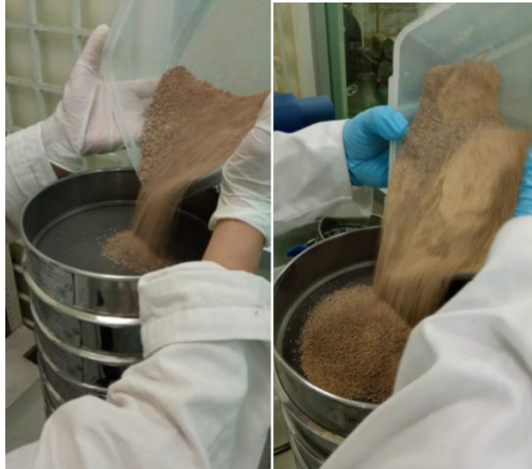
Figura 3.29 Prueba granulométrica de suelo en el sitio de disposición final de Polotitlán, EdoMéx.
