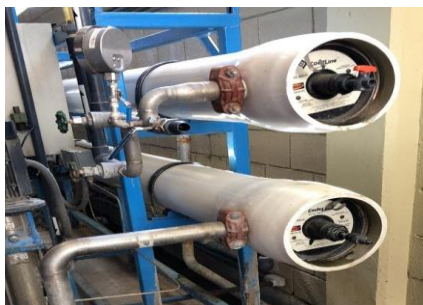
Figura 50 Acoplamientos de los tubos (Elaboración propia) .
