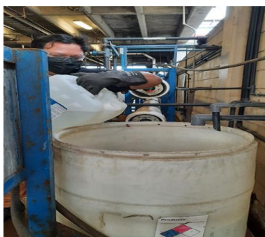
Figura 34 Preparación de solución cáustica (Elaboración propia).
