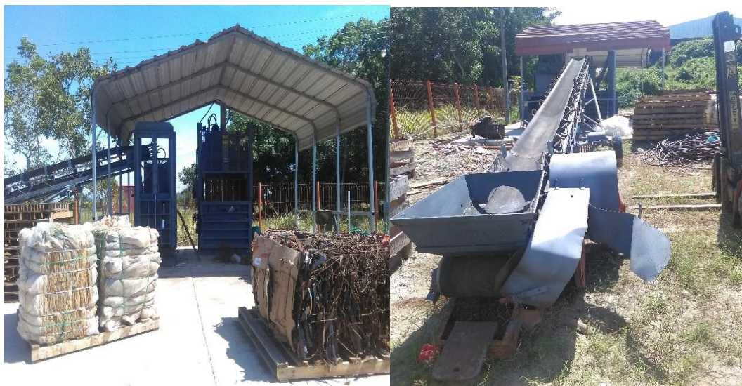
Figura 16 Área de compactación para elaborar pacas de residuos.
