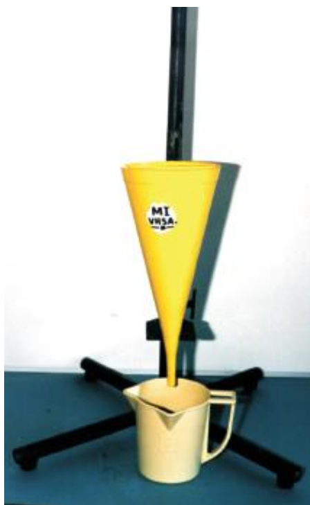
Figura 5. Embudo para medir la viscosidad del lodo (Datalog, 2001).
