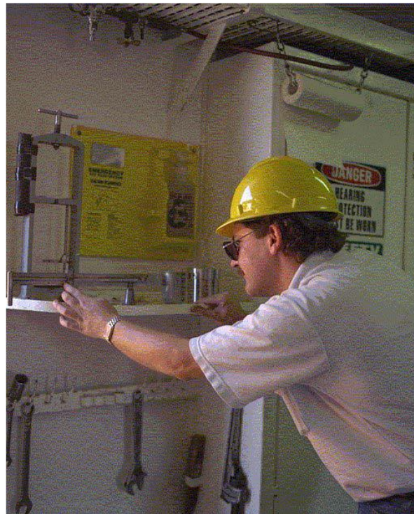
Figura 4. Medición de la densidad del lodo (Datalog, 2001).
