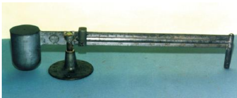
Figura 7. Balanza para medir a densidad del lodo (Fluidos de control, tomo 3).
