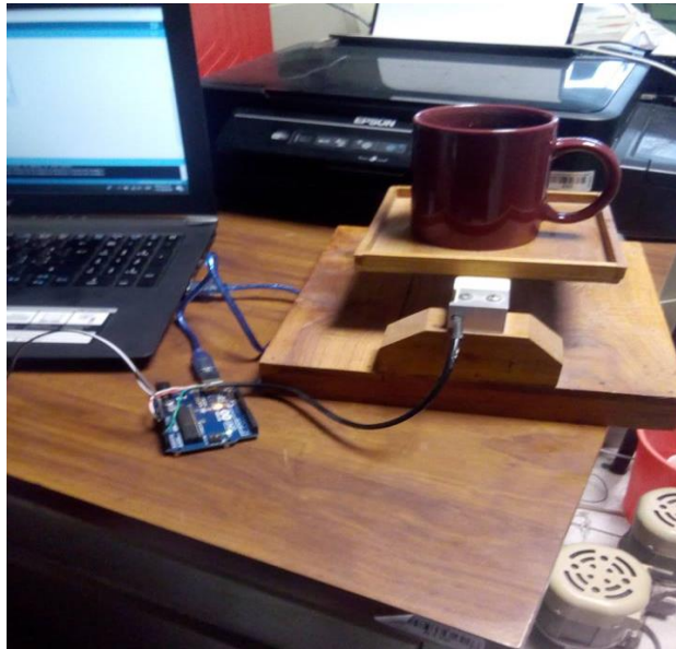
Figura 33. Calibración de la balanza (Fuente propia)
