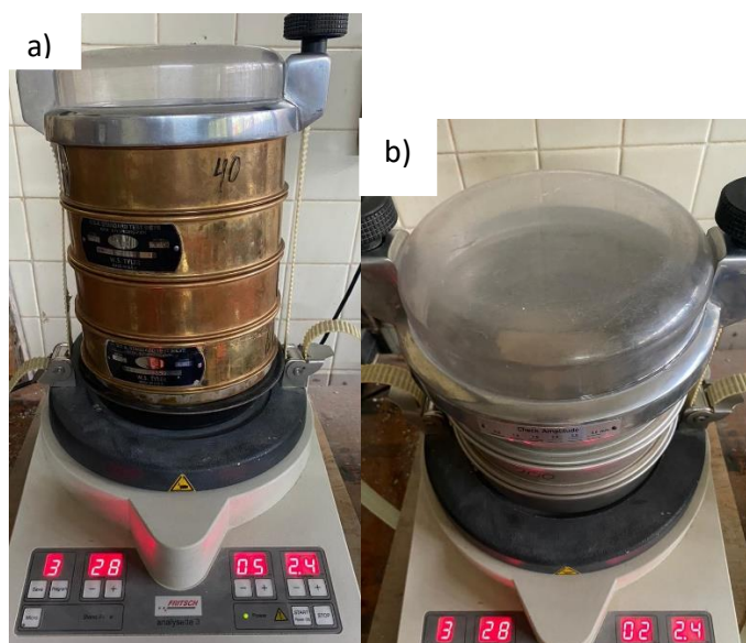
Figura 7.2.1 a) tamices de 40,50,50,80, b) tamices de 100,200,300.
