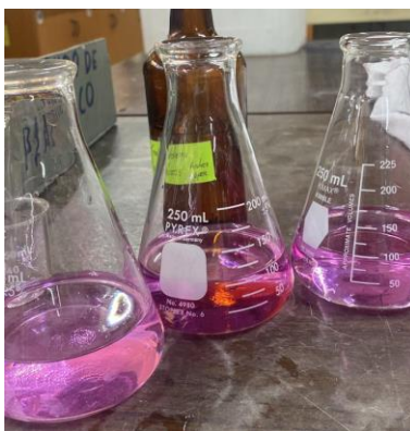
Figura 7.1.4 Determinación de acidez total con fenolftaleína.
