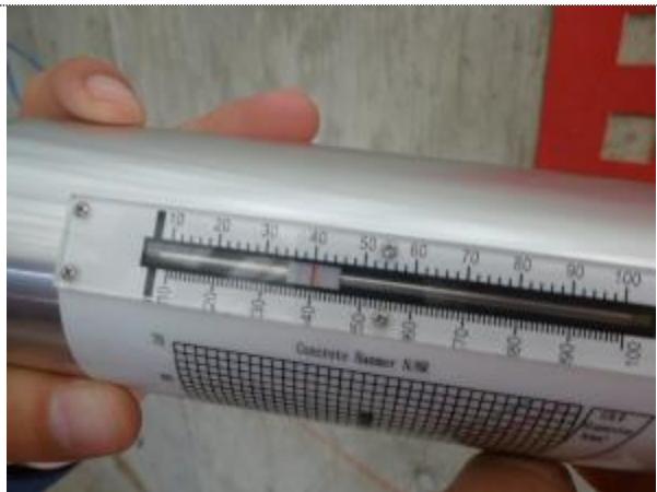
Prueba de resistencia de concreto en castillo, lectura en rango.
