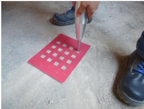
Prueba de resistencia de concreto con esclerómetro, la lectura está en rango.
