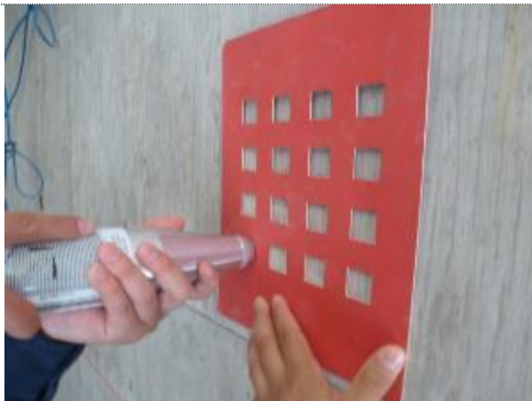
Prueba de resistencia de concreto en castillo, lectura en rango.
