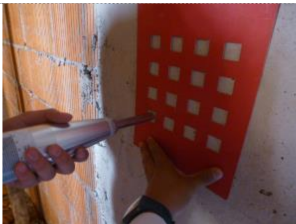
Prueba de resistencia de concreto en castillo, lectura en rango.
