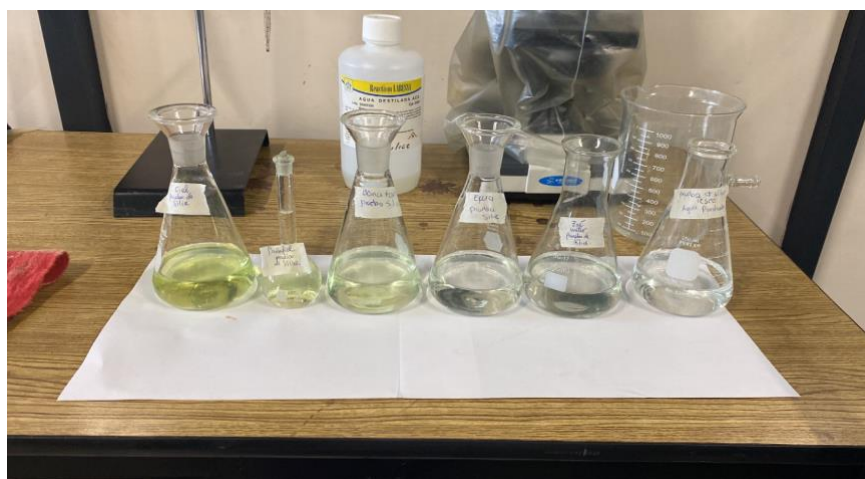
Figura 25. Resultados de la prueba de colorimetría para identificación de sílice en agua
