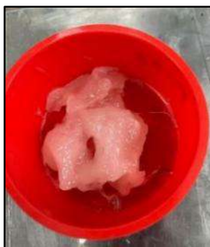
Figura 3.5 Gelificación y aglomeración instantánea de IPN-25/75-S0
