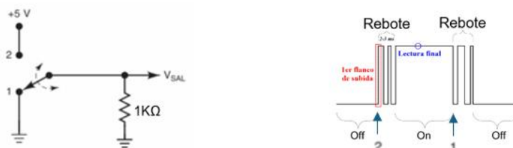
Figura 4.27 Rebote mecánico de un interruptor.
