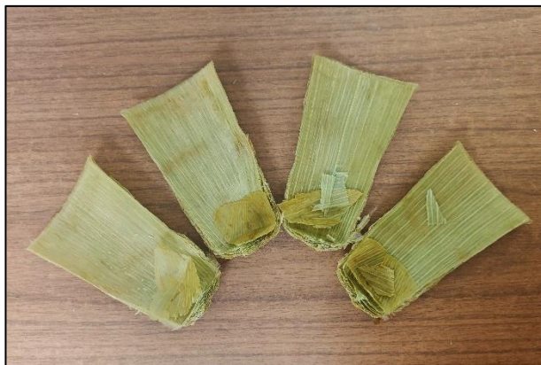
Figura 18. Cortes de vaso para degradación.
