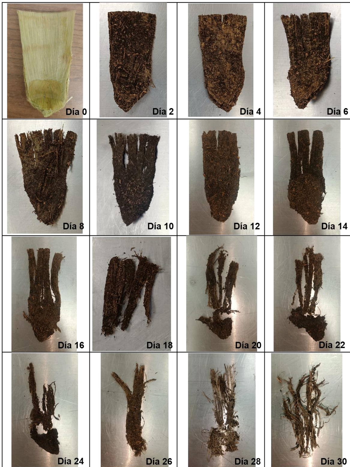
Figura 32. Proceso de biodegradación.
