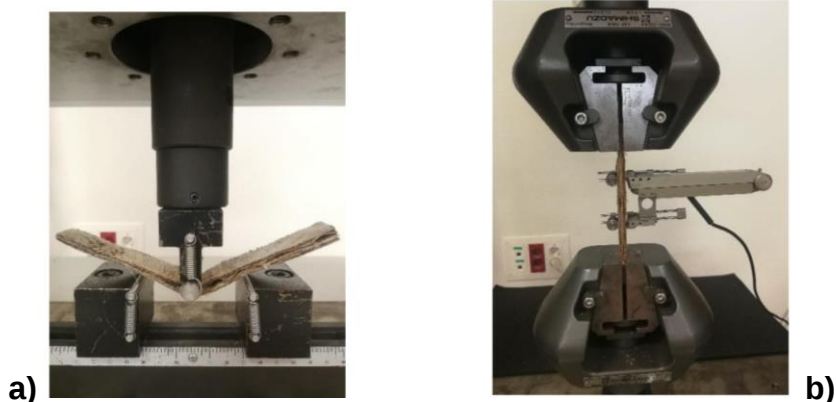
Figura 30. a) Ensayo de flexión y b) ensayo de tracción (Pardo, 2018).
