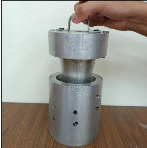
Figura 9. Molde de aluminio Parte A ( A_{AL} ) y B ( B_{AL} ) embonando.
