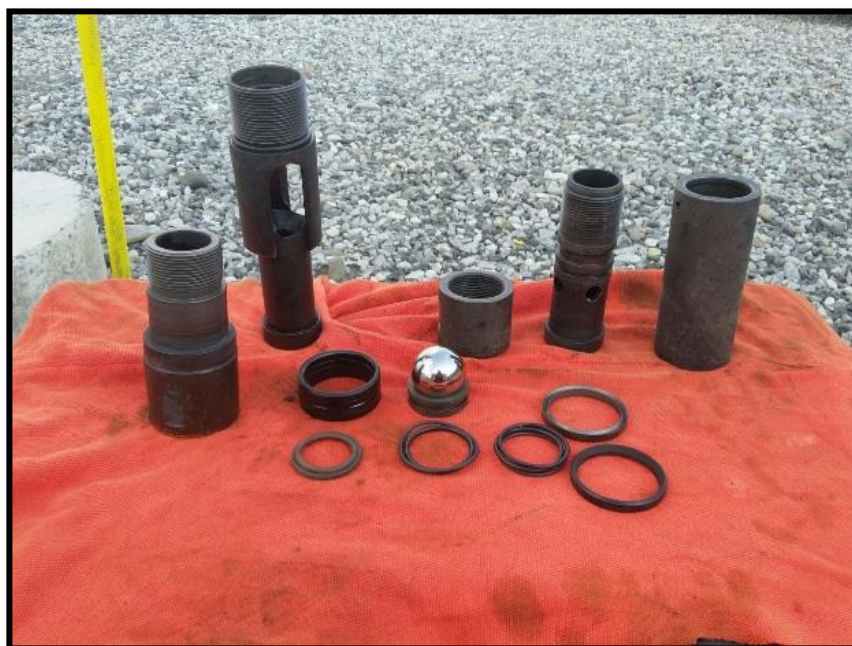
Figura 34. Accesorios de la válvula de pie antes de realizar mantenimiento.
