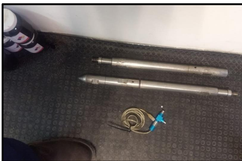
Figura 38. Sonda de memoria después de haber finalizado la toma de información. A su lado interfaz que se conecta a computadora para registrar los datos obtenidos.
