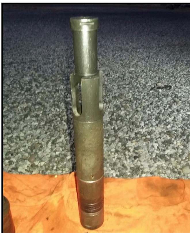
Figura 35. Válvula de pie después de haberse sometido a mantenimiento.
