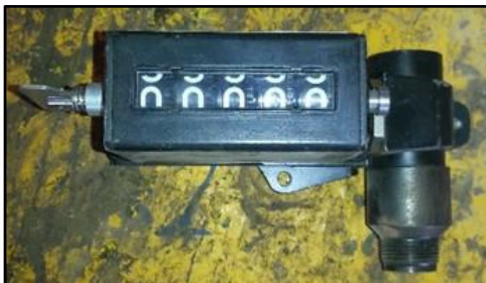
Figura 26. Contador de profundidad que va en la mesa de operaciones.
