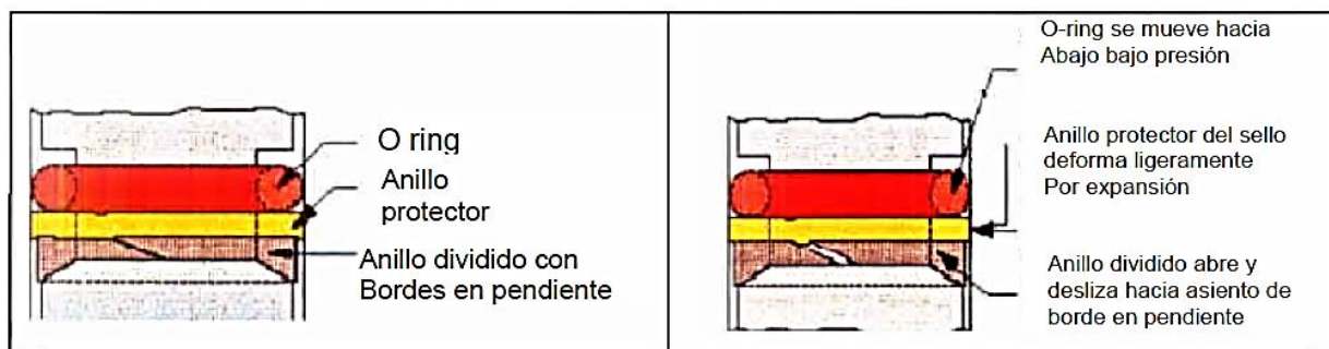
Figura 18. Sistema de tres anillos (izquierda) y sistema de tres anillos sellado contra presión (derecha).
