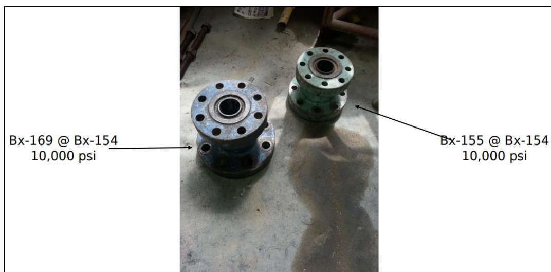
Figura 12. Adaptadores para bridas comúnmente usados en las operaciones de línea de acero (Imagen tomada de: Padrón López, José Francisco (2014) "Línea de acero: Operaciones y Herramientas" (Pág. 10).
