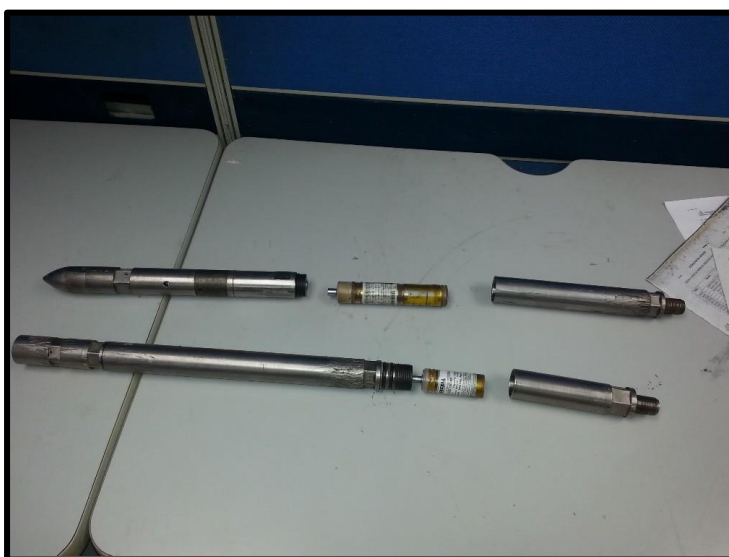
Figura 37. Sonda de memoria con housing y punta de bala antes del procedimiento de toma de información
