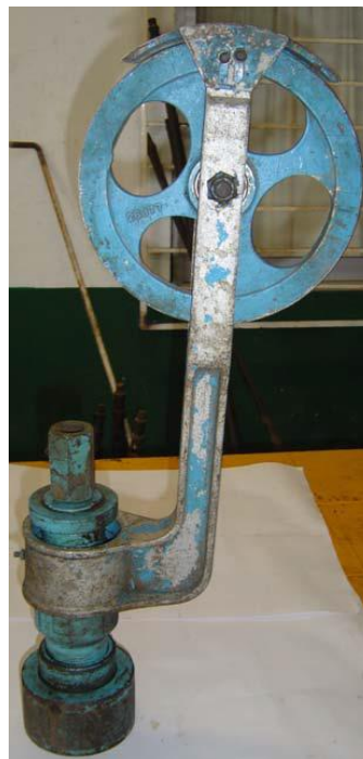
Figura 8. Componentes del estopero Bowen. Imagen extraída de: "Manual de Operaciones con Línea de Acero, PEMEX Perforación y Mantenimiento de Pozos, 2010 (Pág. 27).
