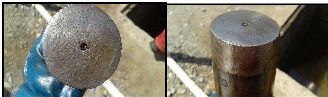
Figura 31. Block de impresión con huella de cuello de pesca.
