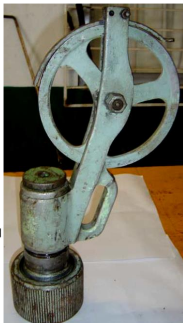
Figura 7. Componentes que conforman el estopero Otis tipo "D". Imagen modificada de: "Manual de Operaciones con Línea de Acero, PEMEX Perforación y Mantenimiento de Pozos, 2010 (Pág. 26).
