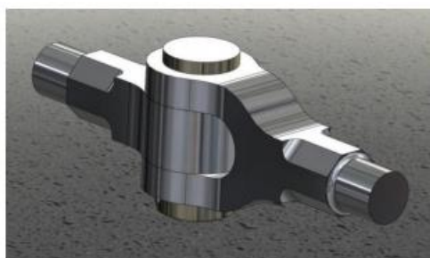
Figura 1.5 Junta de rodillas flexibles (knucklejoint).
