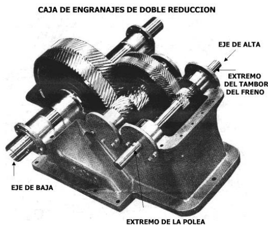
Figura 7 Reductor de Engranes o Caja de Engranes
