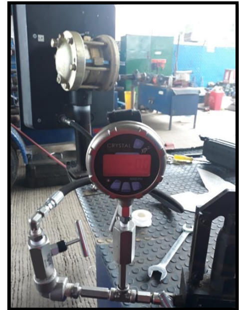
FIG. 20. Bomba y manómetros conectados.
