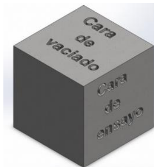
Figura 3. 2 Esquema de las caras de probeta, para ensayo de compresión.
