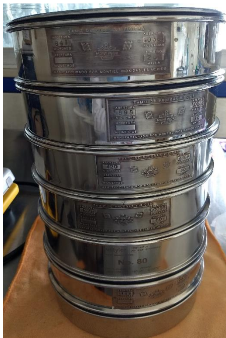
Figura 2.4 Tamices ordenados en forma descendente
