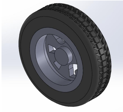
Figura 4-14 Neumático delantero. (145/65 R15)
