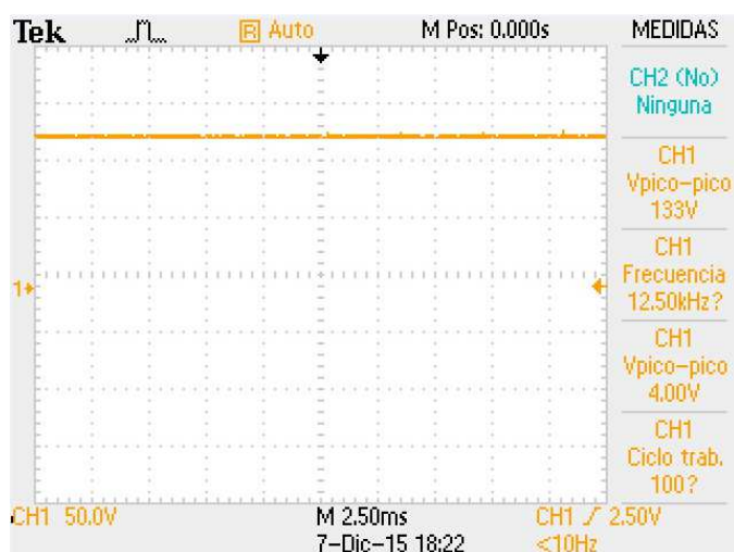
Figura No. 4.3.- Salida de tensión del convertidor.
