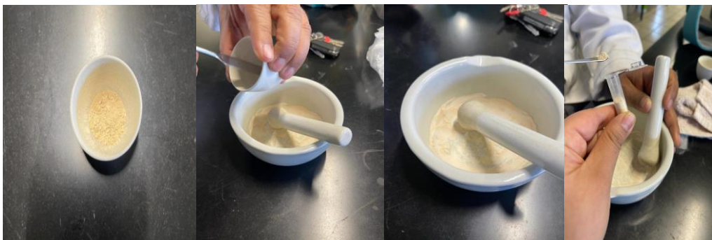
Figura 10 Calcinación de óxido de zinc a 400°C y producto final
