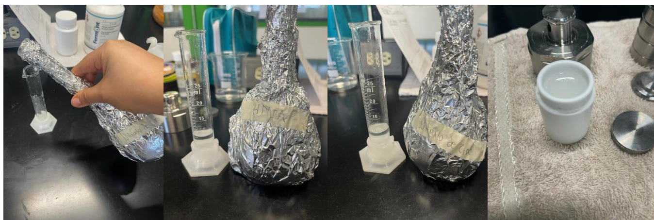
Figura 7 Mezclado de reactivos en el reactor hidrotérmico
