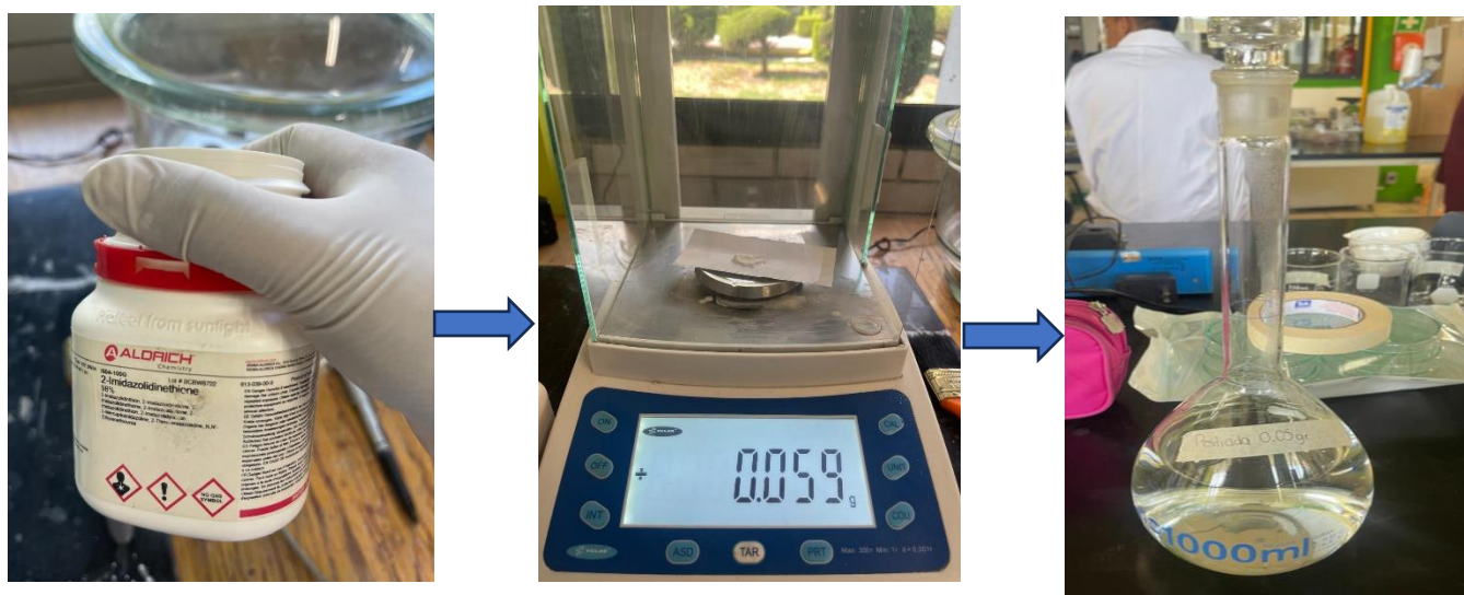
Figura 11 Preparación de solución con pesticida
