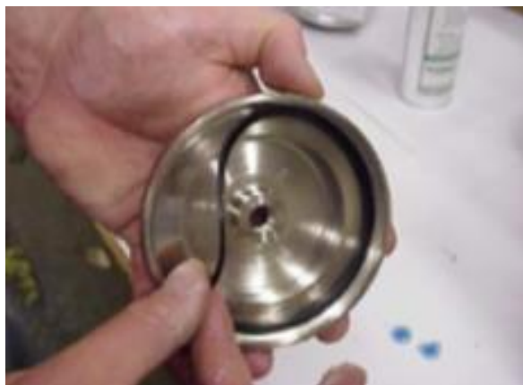
Figura 40: Válvula parte exterior.
