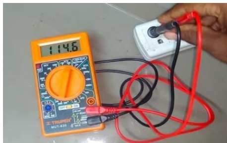
Ilustración 22 Ejemplo del alto voltaje con multímetro
