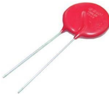
Ilustración 27 Varistor de potencia
