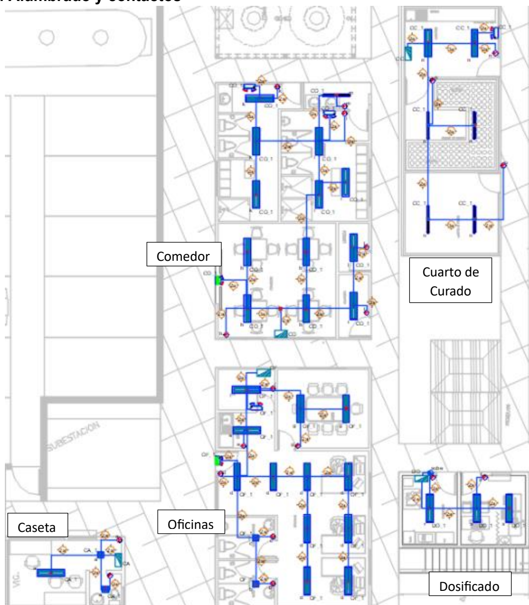
Figura 5.00: Plano de alumbrado dentro de los edificios
