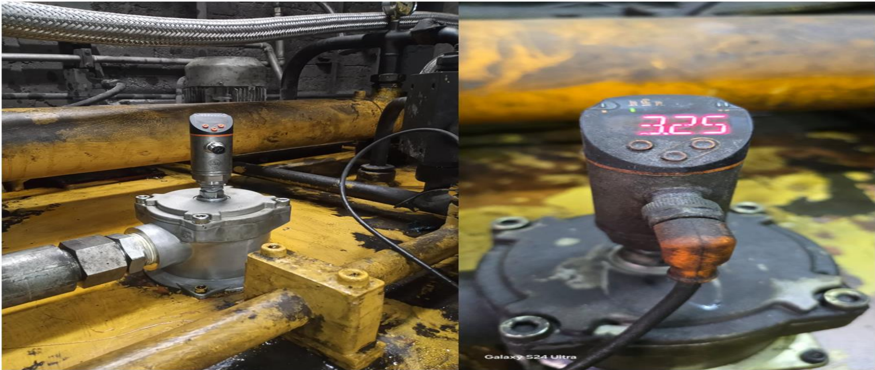
Ilustración 25 Cambio de base filtro e instalación de sensor de presión hidráulico digital (ELECTRONICGMBH)
