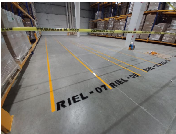
Figura 45. Identificación de rieles en zona de precargas
